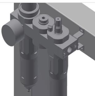
**Блок подготовки сжатого воздуха**
