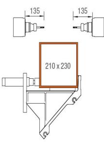
**Область обработки по оси Y и Z**
