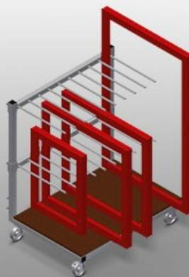
Тележка для внутрипроизводственной транспортировки рам и створок. Прочная стальная конструкция. Тележка с сортировочным гребнем для транспортировки и хранения рам и створок. Опора из твердой древесины. Секционный делитель на 9 рам. Секционный делитель регулируется по высоте. 4 направляющих ролика, из них 2 со стояночным тормозом.
