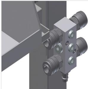
**Пневматическое соединение на 4 штуцера**
