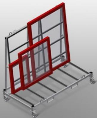
Тележка для внутрипроизводственной транспортировки оконных элементов
