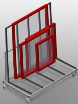
Тележка для внутрипроизводственной транспортировки оконных элементов
