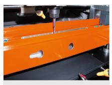
Трехшпиндельный копировально- фрезерный станок KF 178/10
