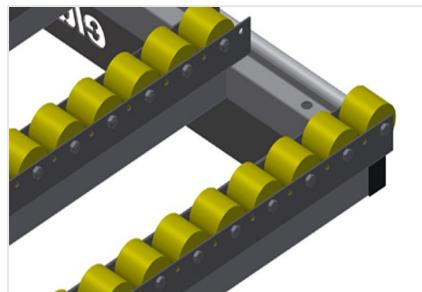
**Роликовая опора в сборе для НТ 2000/Алюминий**
