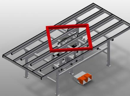
Подъемно-поворотный стол для монтажа и заправки уплотнителя
