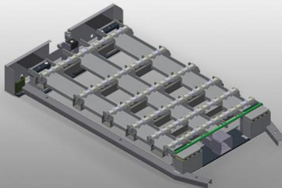
Простое выполнение манипуляций со стеклом в сочетании с тележкой для транспортировки стекла GFW 15. С пневматическим подъемным устройством, управление с помощью ножного клапана, макс. ход = 50 мм. Нижние рольганги оборудованы в общей сложности 15 x 4 роликами из ПВХ. В комплекте со вспомогательным задвижным устройством для тележки GFW 15. Габаритные размеры: 2.100 x 1.250 мм.
