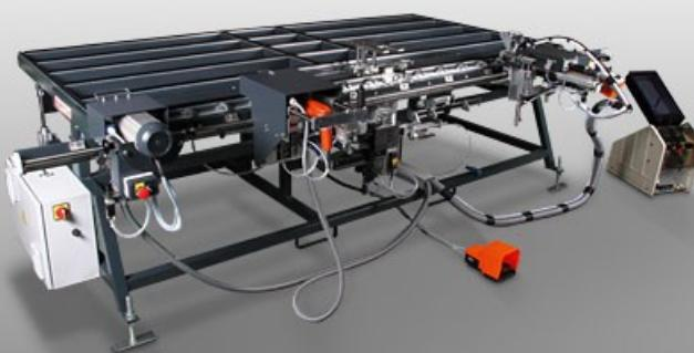
Центр сборки створок для монтажа фурнитуры на пластиковых и алюминиевых оконных створках
