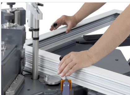
Пресс для стыковки углов EP 124/20
