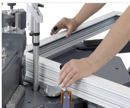
Пресс для стыковки углов EP 124/20 Двуручное управление
