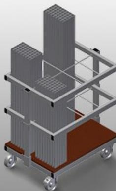
Тележка для транспортировки и сортированной подачи распиленных по размеру армирующих профилей
