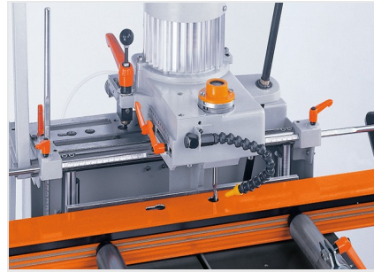
Одношпиндельный копировально- фрезерный станок AS 70/44
