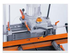
Одношпиндельный копировальнофрезерный станок AS 70/44
