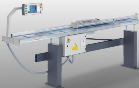
Упорно-измерительная система с автоматической регулировкой длины реза и системой управления позиционированием E 355
