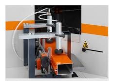
Пила для торцевой обработки профиля AKS V-550
