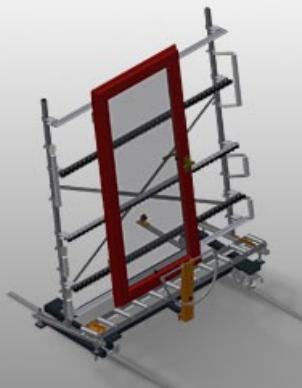
Transportadora vertical de rolos para transportar elementos de janelas
