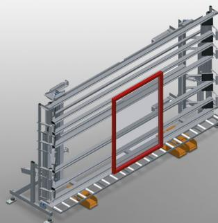
Unidade de controlo e colocação dos vidros para colocar vidros e realizar o controlo final na produção individual e em série
