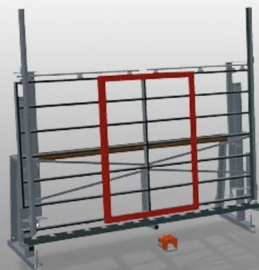
Unidade de controlo e colocação dos vidros para colocar vidros e realizar o controlo final
