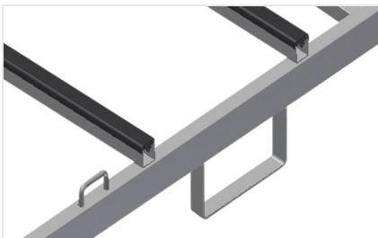
**Estribos para empilhadora e suporte para cintas de fixação**
