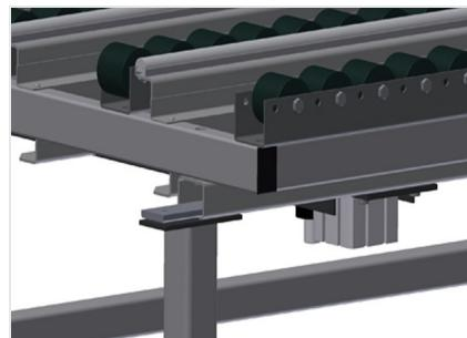
**Dispositivo de elevação pneumático**
