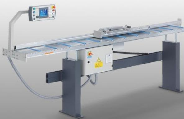
Sistema de batente e medição com ajuste automático dos comprimentos de corte e controlo de posicionamento E 355
