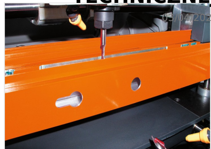
Trójwrzecionowa frezarko- kopiarka KF 178/10
