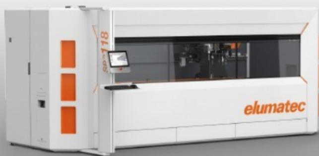
SBZ 118 è un centro di lavoro a 3 assi che prevede un asse aggiuntivo per la rotazione degli aggregati; può eseguire lavorazioni di fresatura, foratura e filettatura dei profili in alluminio, PVC e acciaio a parete sottile.
