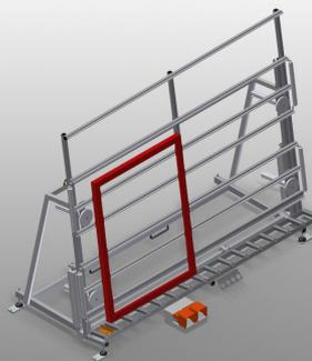
Banco di montaggio per il montaggio verticale
