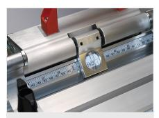
Sistema di battuta e misurazione MMS 100
