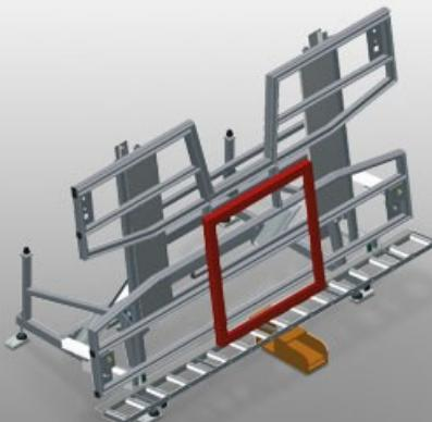
Banco di montaggio per il montaggio verticale e orizzontale
