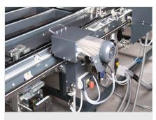
Regolazione pneumatica dell'altezza per scatole di serrature
