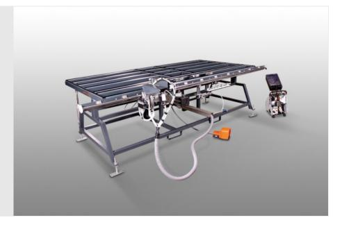
Centro di assemblaggio ante per il montaggio delle ferramenta su ante di finestre in PVC
