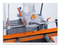
Pantografo a mandrino singolo AS 70/44
