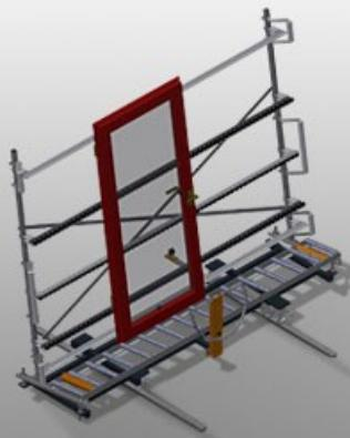
Convoyeur à rouleaux vertical pour le transport des éléments de fenêtre
