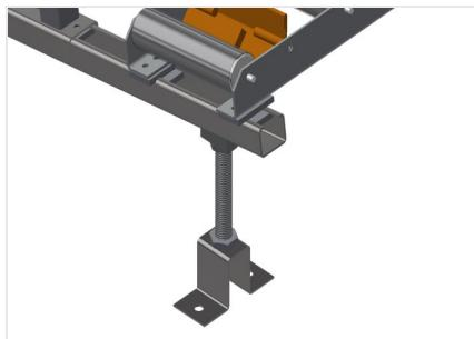
**Réglage en hauteur du convoyeur à rouleaux**
