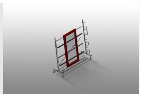
Convoyeur à rouleaux vertical pour le transport et le stockage des éléments de fenêtre
