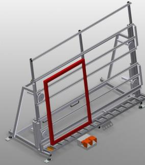
Support d'assemblage pour montage vertical
