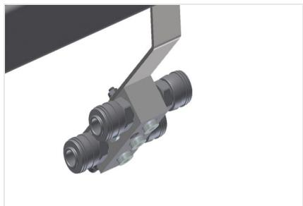
**Raccord d'air comprimé quadruple**
