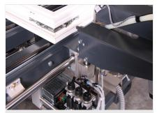
Unités de vissage Unité de vissage mobile à réglage pneumatique de la hauteur.
