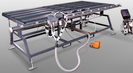
Centre de ferrage pour le montage des ferrures sur les vantaux de fenêtre en PVC
