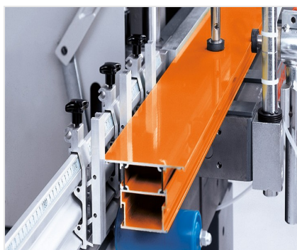
Fraiseuse à copier mono- broche AS 170/10
