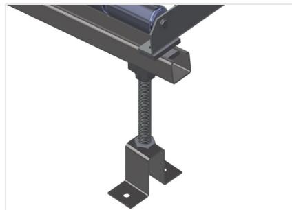
**Ajuste de altura del transfer de rodillos**
