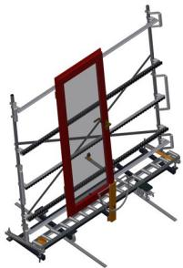
**Transfer de rodillos vertical con dispositivo de desplazamiento y giratorio VR 3000 DF**
