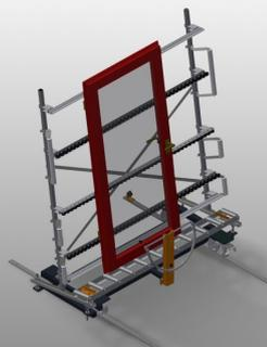
Transfer de rodillos vertical para el transporte de elementos de ventanas
