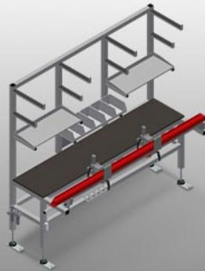
Mesa de montaje para el montaje previo de herrajes y juntas
