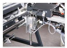
Atornillador con boquilla de tolva de carga manual
