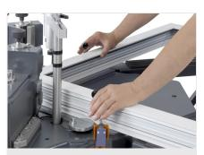
Ensambladora de esquinas EP 124/20
