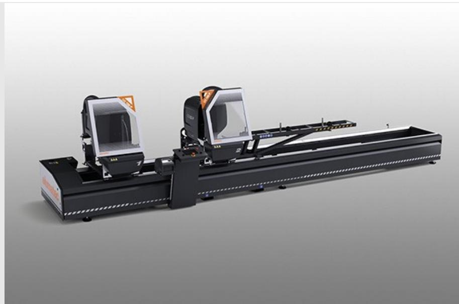
Tronzadora de doble cabezal electrónico con movimiento automático del cabezal móvil mediante motor brushless accionado por un control numérico. Inclinación neumática de los cabezales de corte de 90° hasta 22°30' (externa) en dos posiciones fijas o con sistema opcional mecánico de regulación de los ángulos intermedios. Avance disco oleoneumático.
