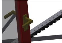
**Röllchenbahn**Drei Röllchenbahnen mit Gummi-Rollen,Durchmesser 50 mm
