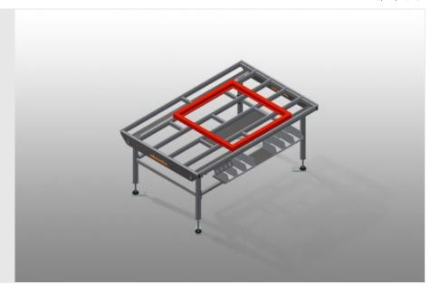
Modularer Arbeitstisch für eine Fertigungslinie (Grundmodul)
