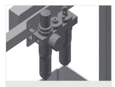
Wartungseinheit Wartungseinheit für Druckluftwerkzeuge
