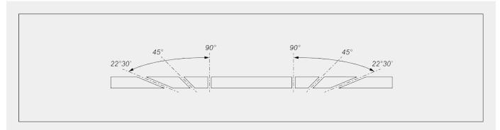
Mechanische Einstellung von Zwischenwinkeln
