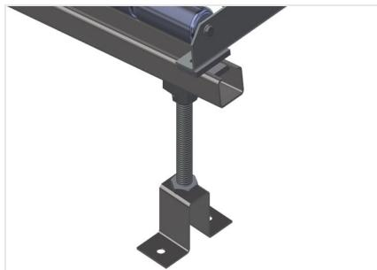
**Réglage en hauteur du convoyeur à rouleaux**
